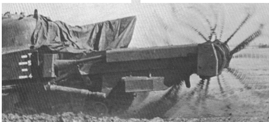
Sherman Crab cséphadarós aknarobbantó harckocsi működés közben. (Forrás: David Fletcher: Vanguard of Victory: The 79th armoured division . London, 1984. 29. o.)
